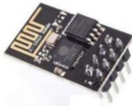
**Figure 8 Wi-Fi module (ESP8266)**
